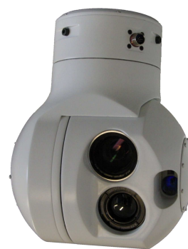
Рисунок 1б. Внешний вид гиостабилизированного подвеса OTUS с телевизионным и тепловизионным каналами
