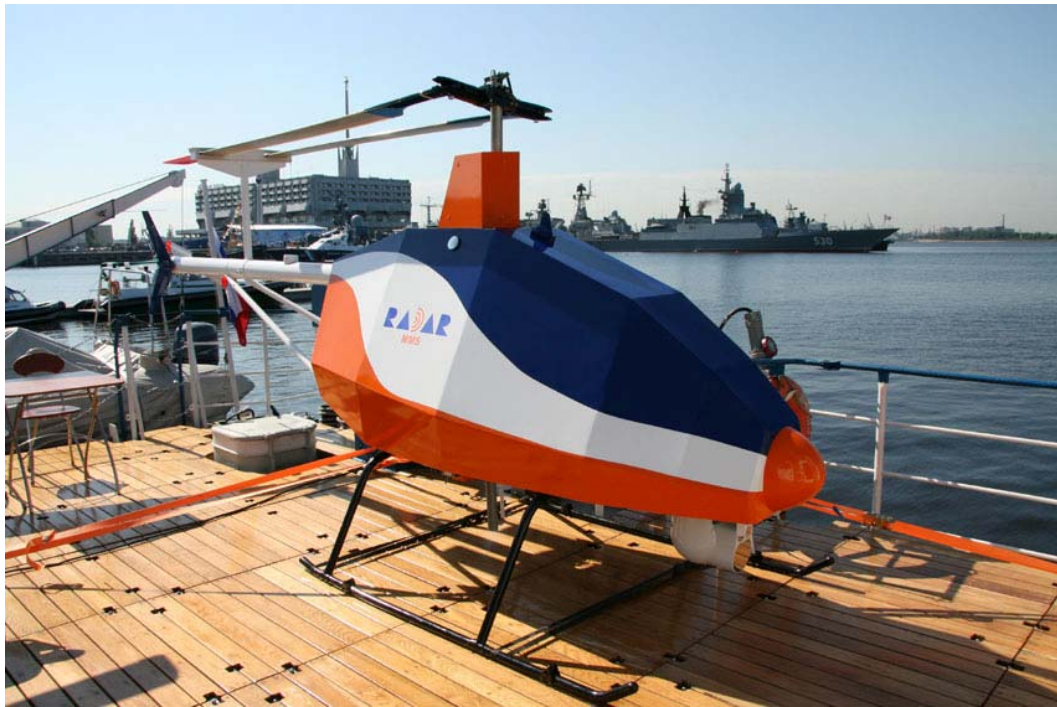
Рисунок 7. Беспилотный вертолет компании «Радар ммс»
