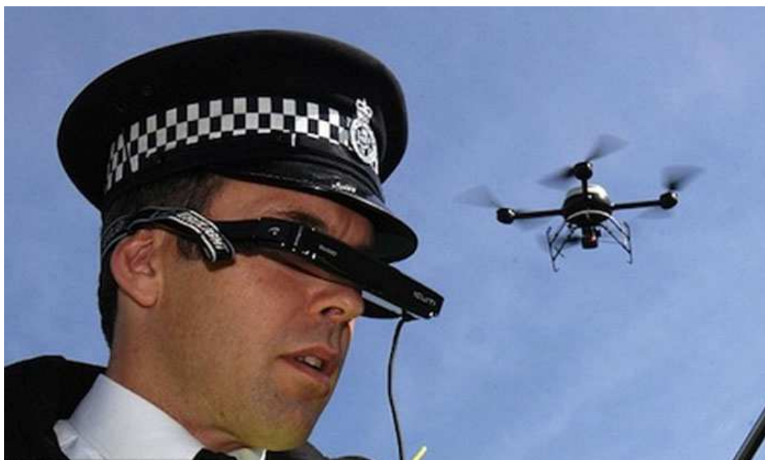
Рисунок 1. Изображение с БЛА может передаваться на специальные видеоочки
