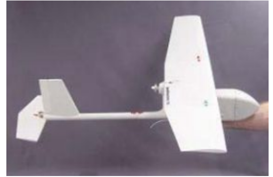
Рисунок 3. БЛА Raven RQ-11B
