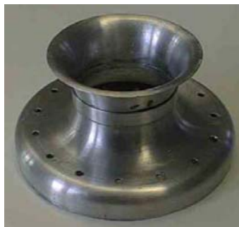
Рис.3. Входное устройство компрессора микро-ТРД
