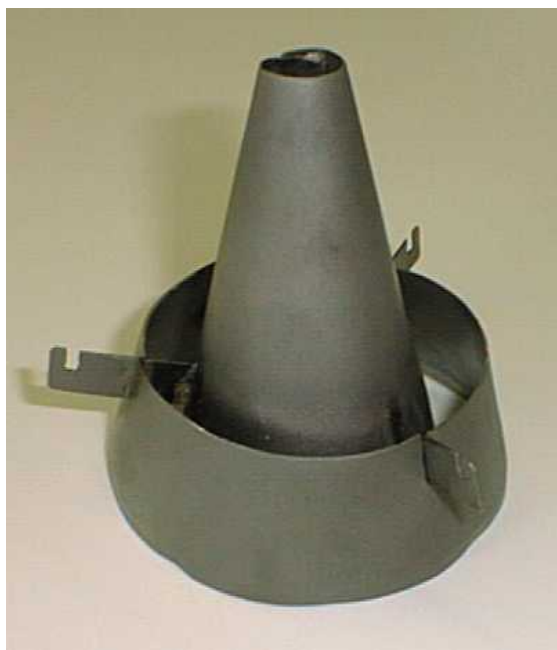
Рис. 5. Выходное устройство микро-ТРД
